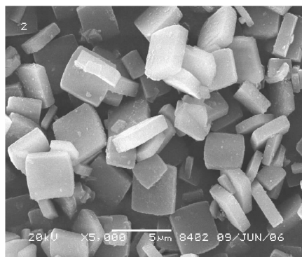
图3 无机钛硅原料体系合成的 TS-1 的 SEM
